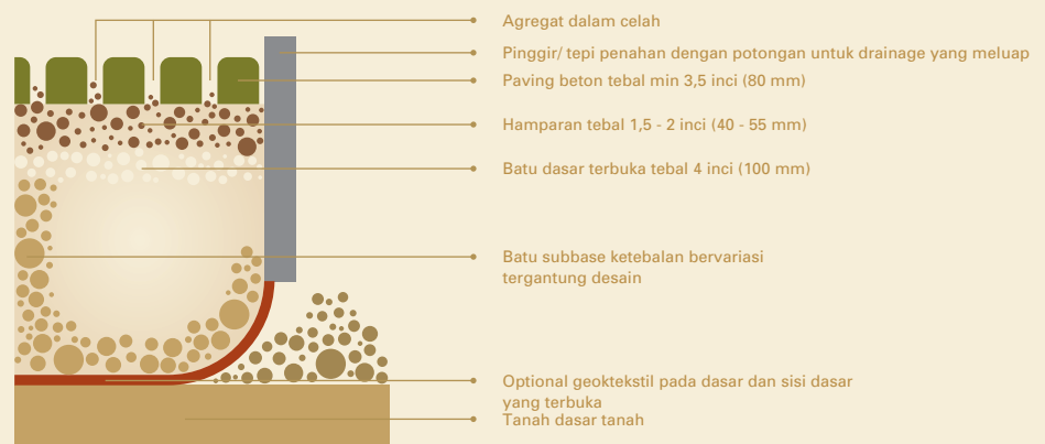
G A M B A R . 2 7 Potongan Melintang Pemasangan Paving Beton dengan Penyambung Berpori
